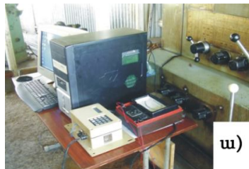
Նկ. 2.23. Ջերմագույգից ստացվող ազդանշանների մշակման, գրանցման և չափման ապարատուրան
