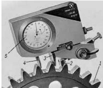
Նկ. 6.42. BB-1080 մականիշի քայլաչափով չափման-ստուգման սխեման
